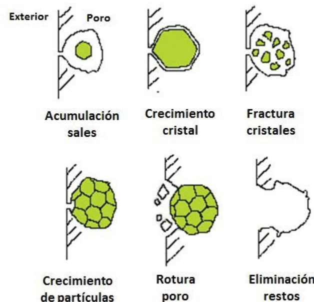
Figura 1: Daño por cristalización de sales en poros. Fuente servicios-edificacion.blogspot
