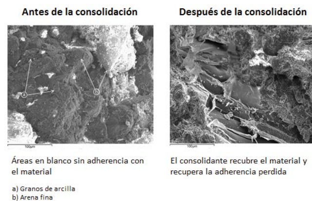
Figura 2: Acción del consolidante. Fuente Ferron, 2007
