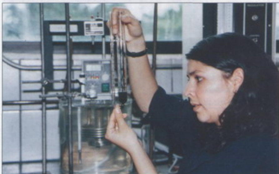
La laboratorista química del LANAMME, Vivian Bonilla, realiza pruebas para medir la viscosidad del asfalto y verificar que cumple con las especificaciones.
