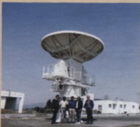
Fig. 2 Fotografía que muestra una antena rastreadora de señales de cuásar, localizada en Tsukuba, Japón. Esta estación es "portátil", porque se desarma, puede ser trasladada e instalada para mediciones en otros sitios. El autor aparece al extremo derecho.
