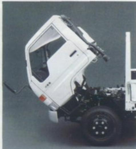
La basculación de la cabina se caracteriza por un sistema de barra de torsión doble que permite un ángulo de inclinación de 45 grados.
