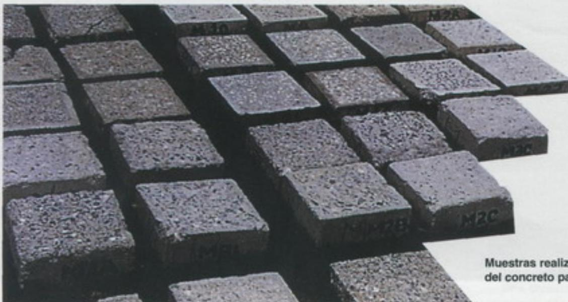
Muestras realizadas para la selección del color del concreto para el edificio.
