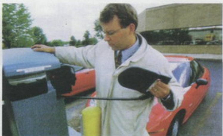
El sistema de carga inductivo elimina la necesidad de contactos a la hora de recargar las baterías. El proceso dura tres horas.
