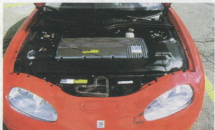
Control electrónico: el corazón del EV1, alojado bajo el capó, controla todas las funciones importantes del vehículo.
