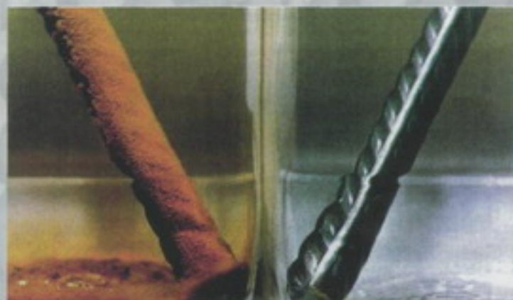
Foto 2. Efecto del inhibidor de corrosión (derecha) sobre barras de refuerzo sumergidas en una solución de cloruros.
