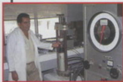
LABORATORIO FISICO Prensa hidráulica para fallar cubos de cemento.
