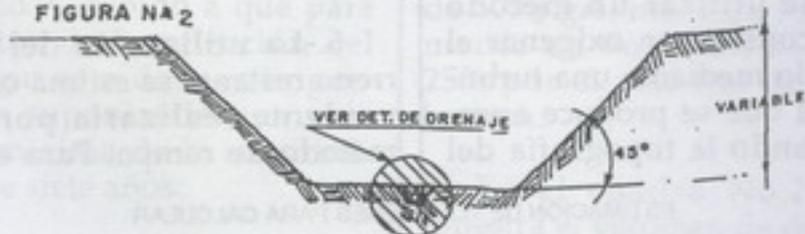
CORTE DE TRINCHERA ESC. 1:100
