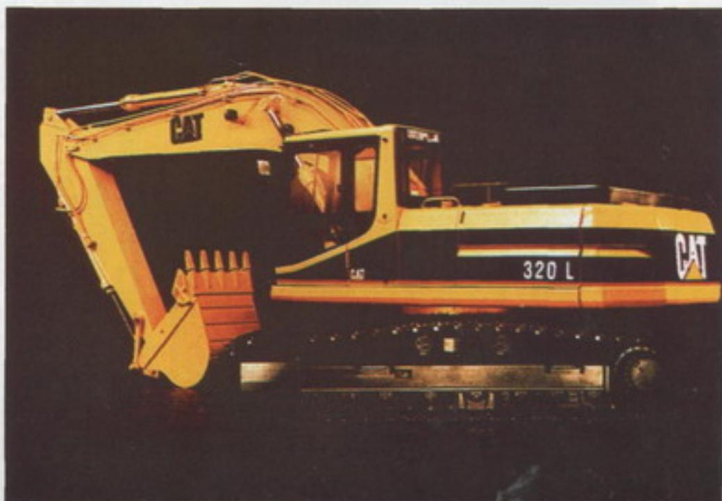
Modelo 320L. Motor Caterpillar 3116 de 128 HP (96 KW). Peso de operación 20.900 Kg., capacidad del Cucharón 1.40 m<sup>3</sup>.
