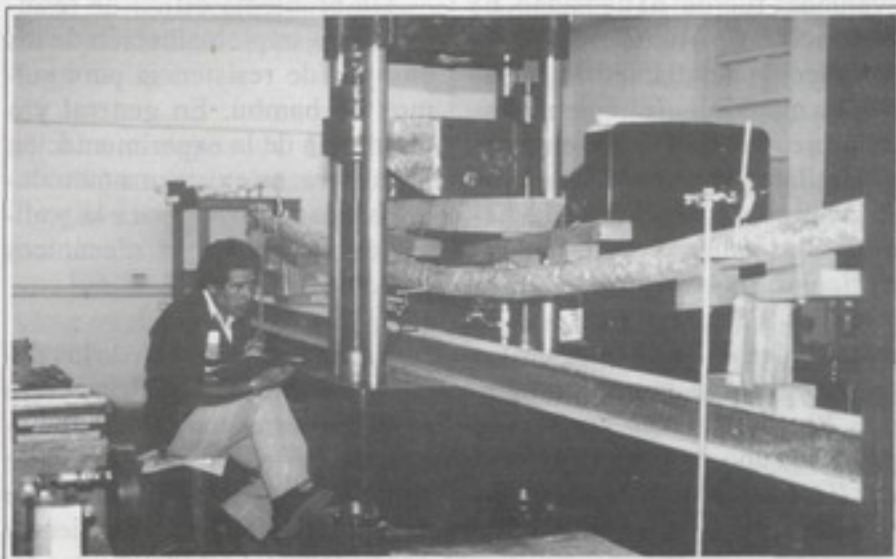
Ensayo de flexión con culmos de 5 m de longitud.
