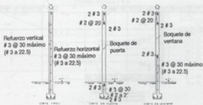
Figura No. 3.8.6. Corte típico, corte en puerta y corte en ventana en concreto reforzado.
