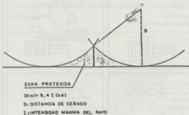
Figura 4 - Zona de protección por una punta vertical
