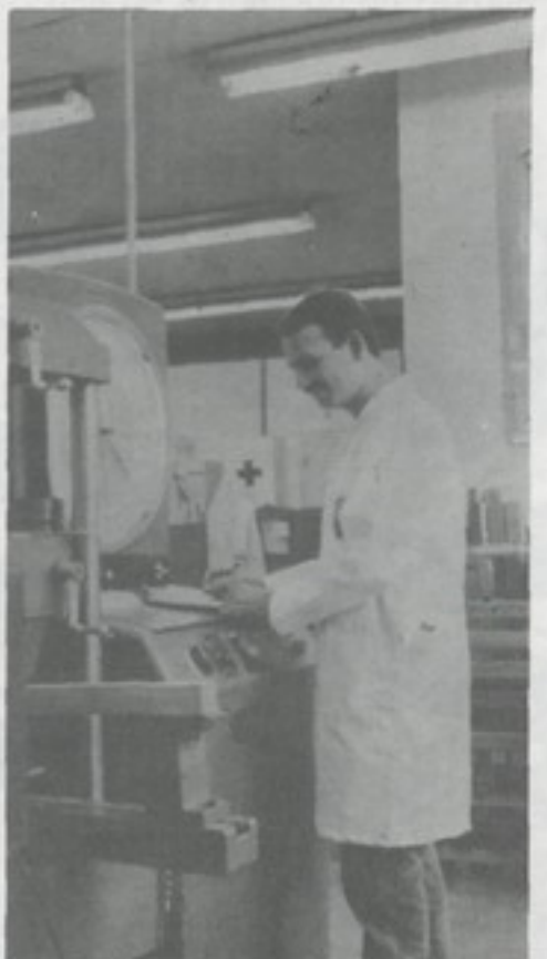
Prueba de flexión estática en madera de "Canfín".
