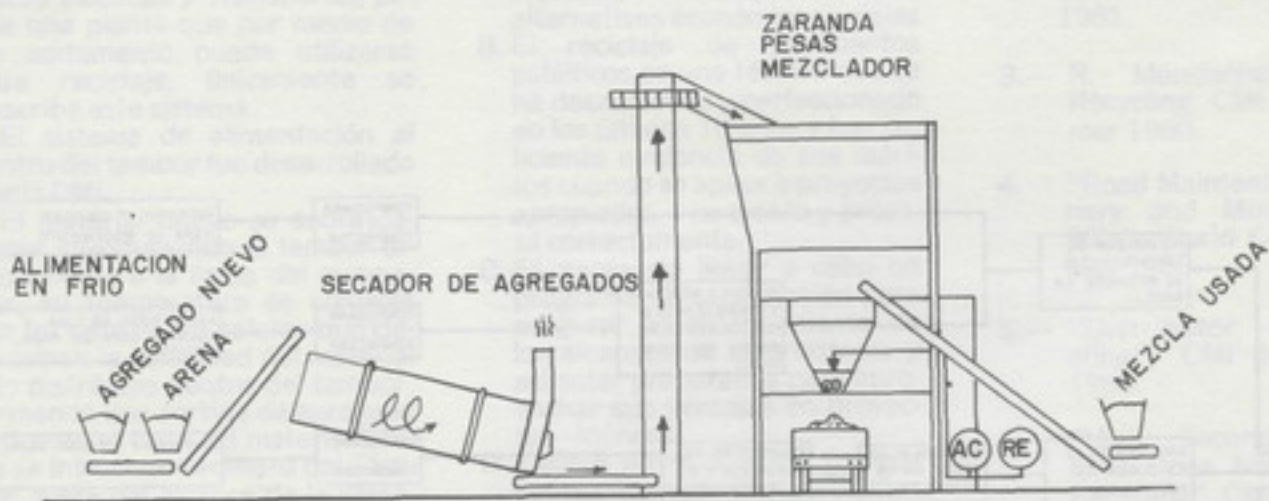
DIBUJO 1. — PLANTA PARA PESAR POR BATIDA CON ADITAMENTO PARA AÑADIR AGREGADOS USADOS EN EL MEZCLADOR. —
