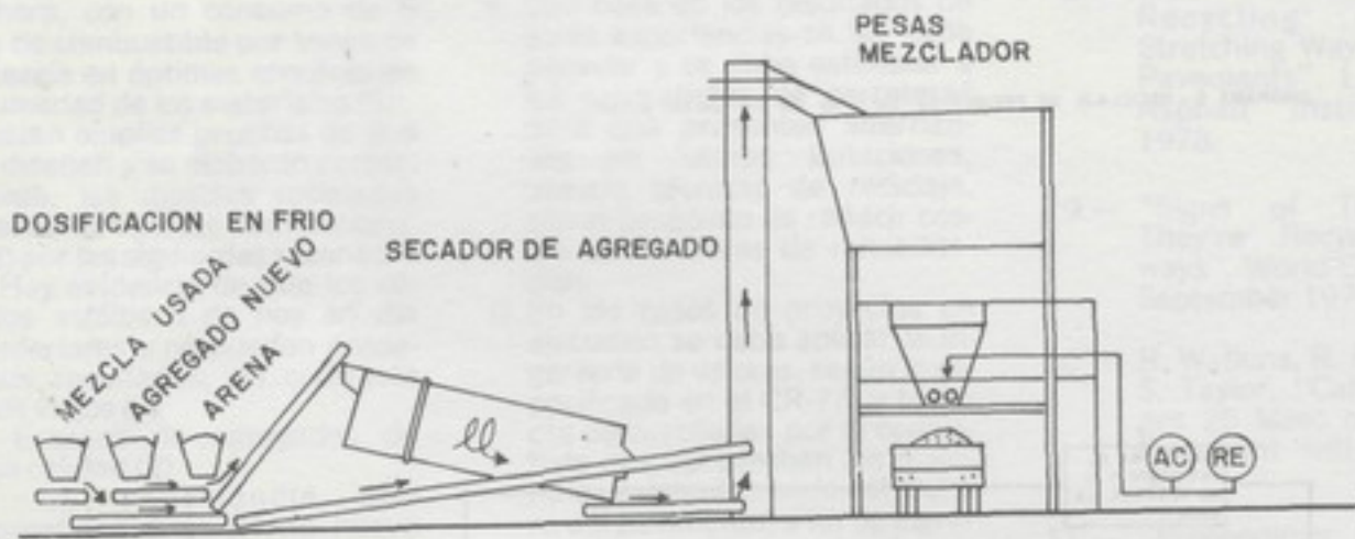
DIBUJO 2. — PLANTA PARA PESAR POR BATIDA CON ADITAMENTO PARA AÑADIR AGREGADO USADO EN EL ELEVADOR. —
