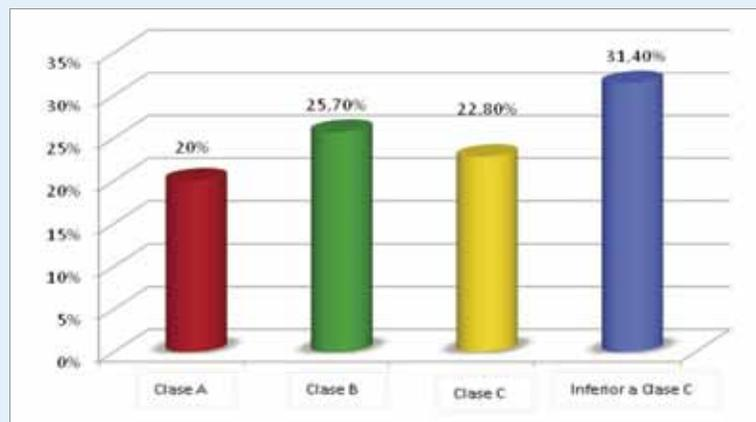
Gráfico 3. Resistencias de los concretos de relleno de los bloques
