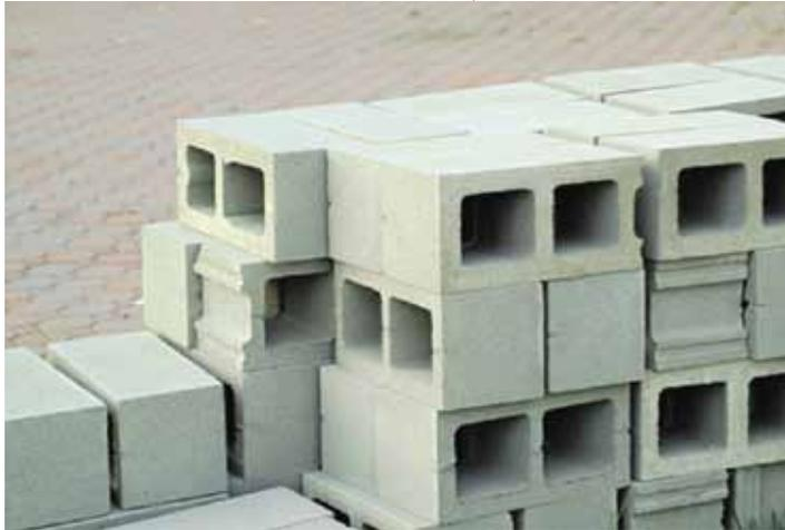
La mampostería de bloques de concreto es el sistema más usado en el Área Metropolitana para construir paredes en una vivienda. Está compuesto por los bloques, que se adhieren con mortero de pega, varillas de acero horizontal y vertical para aumentar la resistencia y concreto para rellenar los huecos de los bloques.
