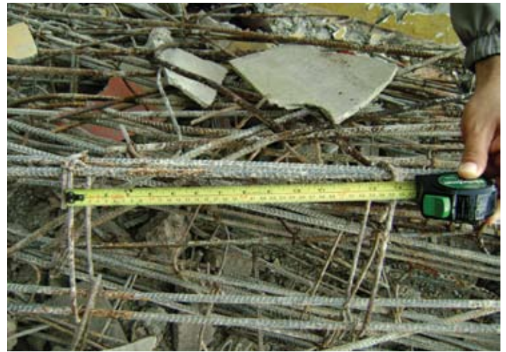
Aros con una separación de 33 cm, incumpliendo las recomendaciones del CSCR.
