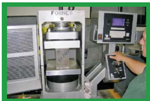
Falla de un bloque de concreto en laboratorio.
