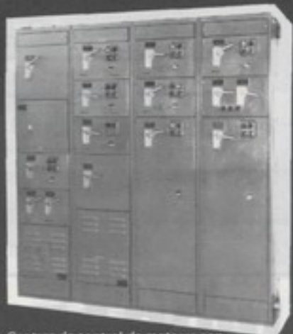
Centros de control de motores con combinaciones de arrancador e interruptor termomagnético. Arrancadores a tensión plena o reducida. Barras principales de hasta 2000 amperios. Tensión máxima de 600 voltios.
