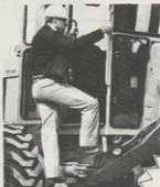
MOTONIVELADORA JD 672-A MOTOR DIESEL JOHN DEERE DE 125 CABALLOS DE FUERZA.
