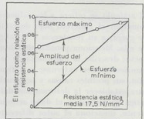
Figura 3 Diagrama modificado de Goodman para resistencia a la fatiga —a 2 millones de ciclos— del concreto en compresión (Graf y Brenner)
