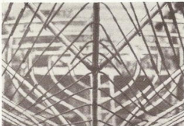
*Detalle de la estructura de caños y barras que conforman el casco.*
