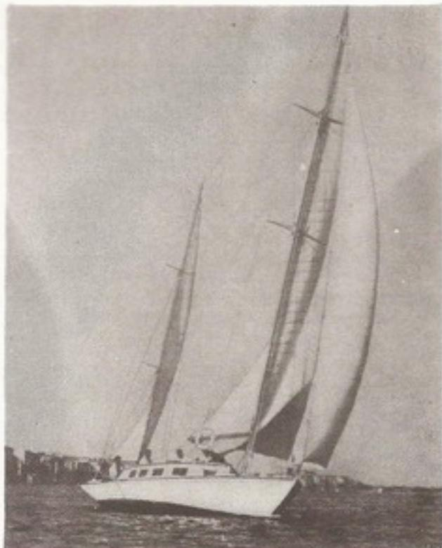
*Velero con casco de ferrocemento construido por el Prof. Nervi en 1948.*
