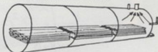
PERIODO DE VACIO Se cierra herméticamente el cilindro y se crea un vacío al máximo eliminando al aire en todas las células de la madera aumentando su recepción para el tratamiento.
