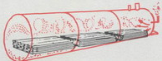
VAPORIZACION Y ACONDICIONAMIENTO. Madera sujeta al período de vaporización, abiendo las células, extrayendo resinas, azúcares y humedad, preparando el material para el período de vacío.
