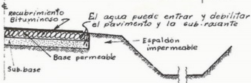
FIG.5-DRENAJE DE LAS CAPAS DEL PAVIMENTO
