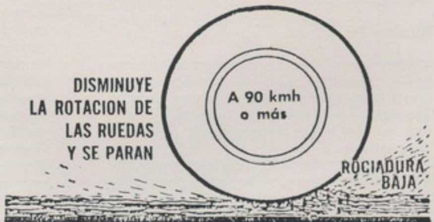
A una velocidad de más de 90 kmh, la cuña de agua puede aumentar y el neumático deja de tener contacto completo con la calzada, produciendo hidroplaneamiento total.
