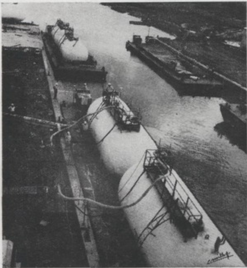
Descargando amonio anhídrico en la terminal
