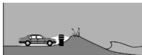
Figura N°2 - Ejemplo de iluminación de un estacionamiento cerca de una playa en la cual el punto de luz se mantiene a baja altura y con una fuente de luz de baja potencia
