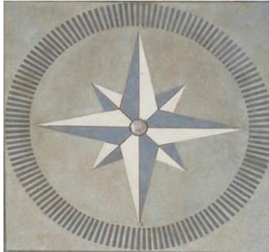
Hito colocado en el parqueo de la casa CIT. Coordenadas. Marco de Referencia": Época 2014,59. Posición Sistema CRTM. Coordenada Este 495738,58 m. Coordenada Norte 1097477,90 m. Posición WGS84. Longitud 84° 02' 19,90" W. Latitud 09°55' 30,91" N.
