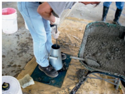
Prueba de revenimiento (ASTM C143)
