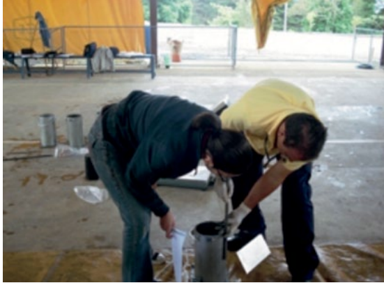
Elaboración de especímenes de concreto (ASTM C31)
